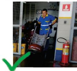
4. **Nunca jogue ou arremesse os produtos** durante a descarga. Quando houver diferenças de altura entre o veículo de transporte e o piso, utilize uma prancha de madeira colocada do veículo ao chão, acomodando a base a uma superfície macia (ex: pneu), para evitar impactos fortes no produto.
